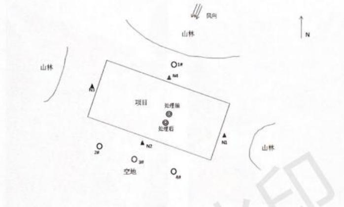
注: ⊙为有组织废气监测点; ○为无组织废气监测点; ▲为噪声监测点
