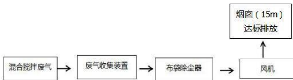
图 4-2 项目混合搅拌废气处理流程图
