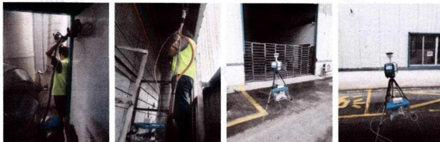
喷粉、烘干工序废气处理前    喷粉、烘干工序废气排放口    厂界上风向参照点 1#    厂界下风向监控点 2#
