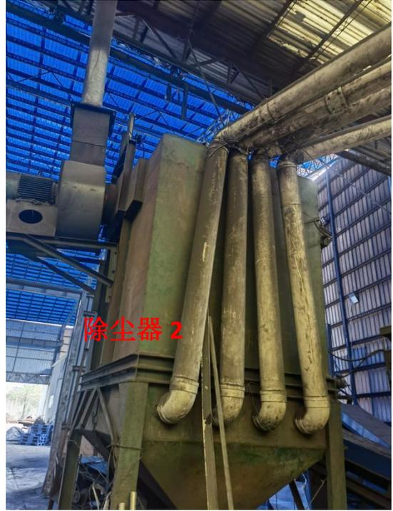
图 4 脉冲布袋除尘器 2 整体照片
