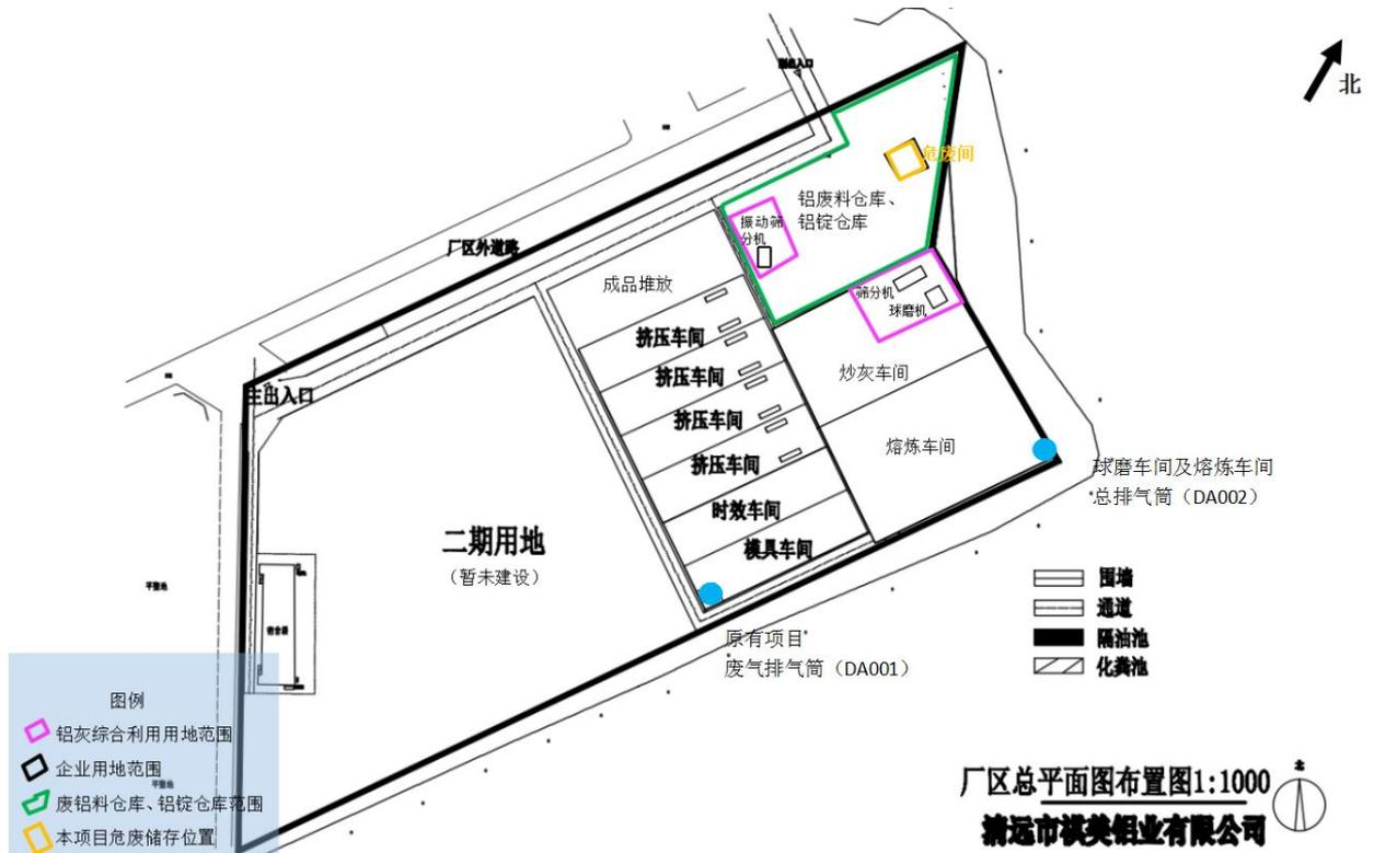
图 3-5 项目平面布置图及排气筒设置（本次验收实际建设）
