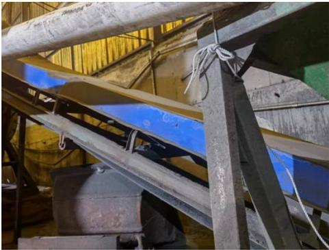
图 7 输送带加盖围蔽
